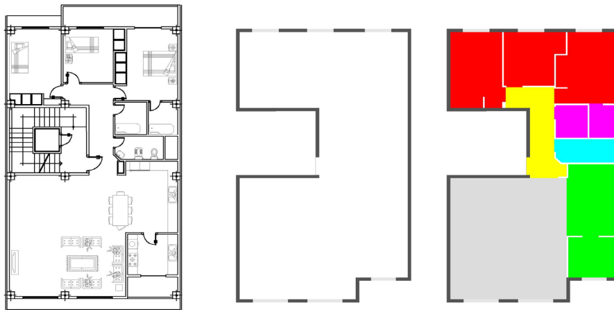
شکل ۲: برچسب زدن پلان‌های معماری برای آموزش مدل هوش مصنوعی سی-گن (چپ: پلان اصلی، وسط: تصویر ورودی، راست: تصویر برچسب گذاری شده خروجی)
