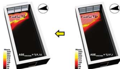
شکل ۷: از آنجایی که در اینجا مقدار ASE_{1000/250h} از حداکثر میزان قابل قبول ۱۰ درصد تجاوز نموده راه حل اول استفاده از سایبان می‌باشد.
