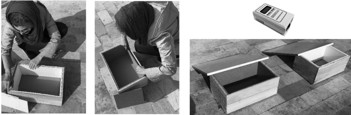
شکل ۶: ساخت نمونه‌های میدانی جهت آزمایش نتایج دمایی توسط دیتالاگر
