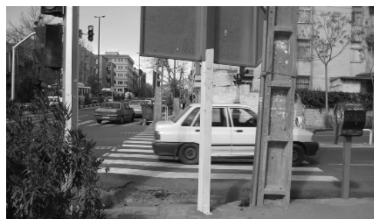
شکل ۳: عدم توجه به رفع موانع در مناسب‌سازی تقاطع‌ها
