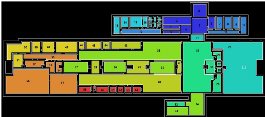
شکل ۶: تجزیه و تحلیل فضاهای محدب به روش نحو فضا برای جهت‌گیری در طبقه زیرزمین اول ایستگاه میدان ساعت
