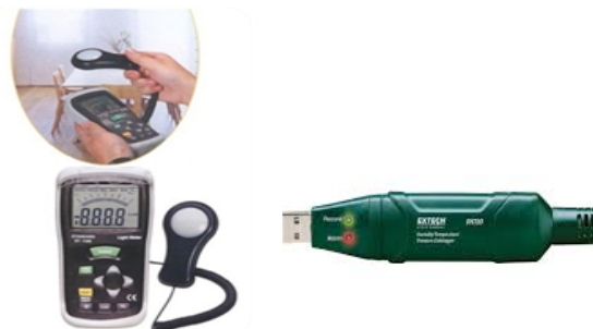
شکل ۱: حسگرهای حرارتی (راست)، مدل استاندارد و لوکس‌متر (چپ)
