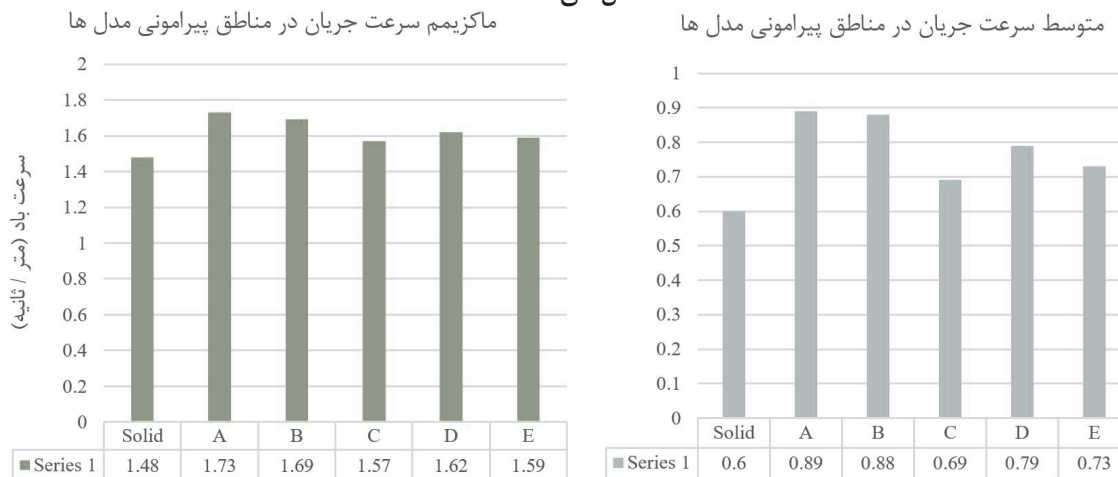
شکل ۹: نمودارهای میانگین مقادیر به دست آمده برای متوسط و ماکزیمم سرعت جریان در مناطق ۸ گانه پیرامونی مدل های A-E
