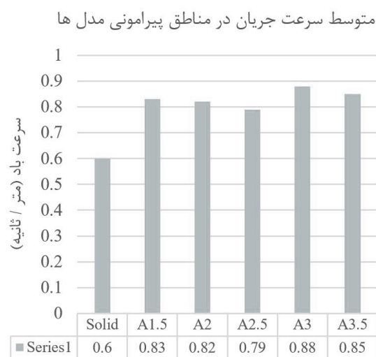
شکل ۱۱: نمودارهای میانگین مقادیر به دست آمده برای متوسط و ماکزیمم سرعت جریان در مناطق ۸ گانه پیرامونی مدل‌های A1.5- A3.5
